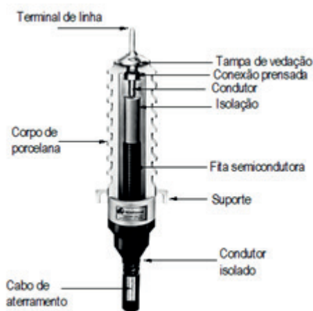
Figura 6 – Componentes internos de uma mufla singela
